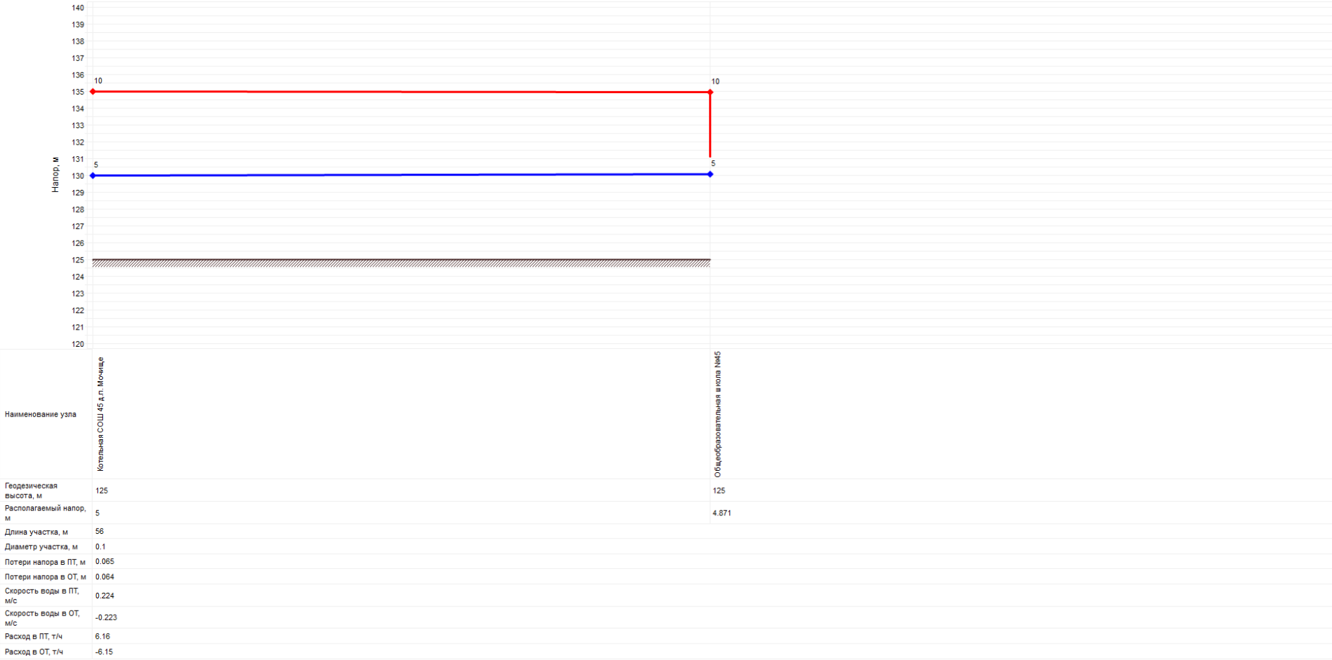
Рисунок 3.36 – Пьезометрический график от котельной СОШ 45 д.п. Мочище до потребителя «Общеобразовательная школа №45» и гидравлические характеристики участков данного пути
